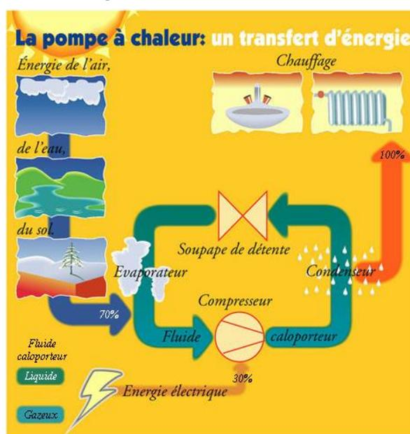
Figure 9 : principe de fonctionnement des pompes à chaleur (source [www.airclim-concept.com](http://www.airclim-concept.com))
