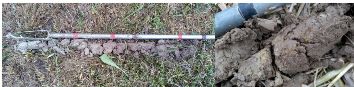
Figure 38 : Echantillon rédoxique caractéristique d'une zone humide (DCI Environnement)
